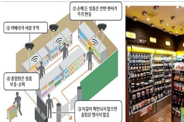
전용 게이트를 통해 입장 후, 구입을 원하는 상품을 집어 들면 시카메라, 선반 센서가 이를 감지하고 결제 단말기 모니터에 상품 명과 가격이 자동 표시 결제되는 방식
